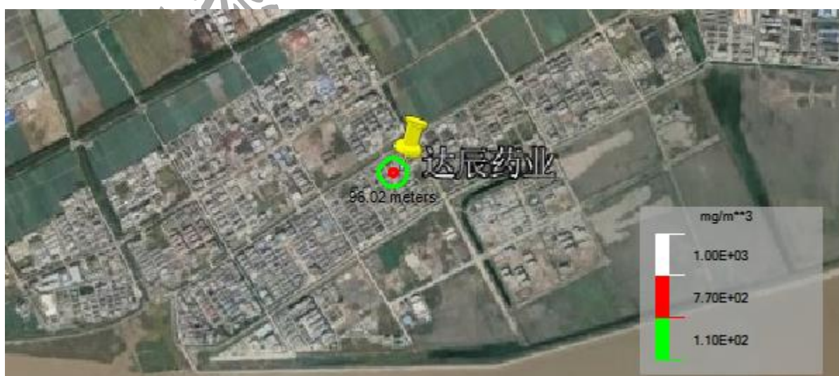
图 6.3.5-10 氨气钢瓶泄漏影响范围预测图（最常见气象）
